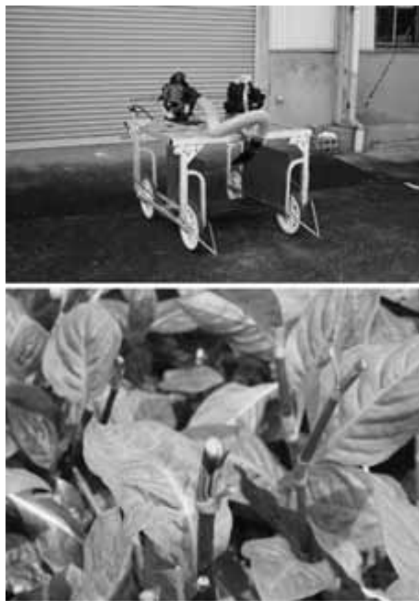
図7 開発したタデアイ簡易収穫機 上：開発したタデアイ簡易収穫機全体 下：タデアイ簡易収穫機による刈り取り後の茎断面
