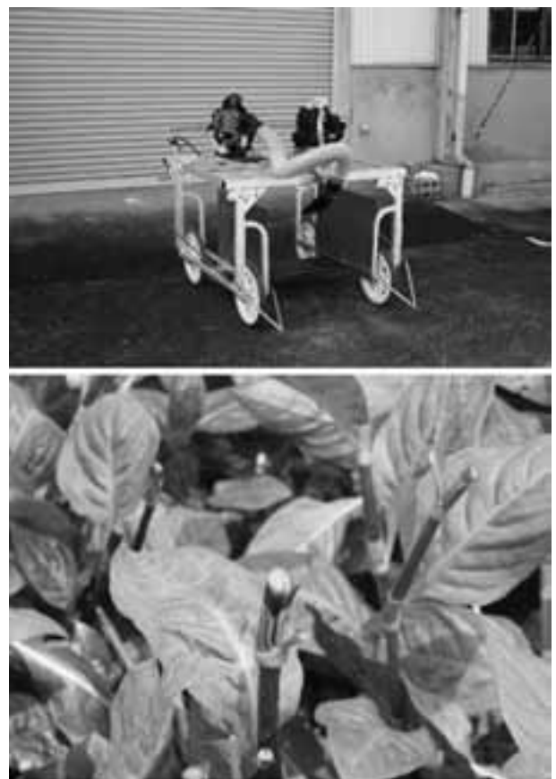
図7 開発したタデ藍簡易収穫機 上：開発したタデ藍簡易収穫機全体 下：タデ藍簡易収穫機による刈り取り後の茎断面
