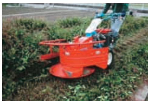
歩行型ロータリーモアによるタデアイ収穫試験 (96ページ参照)
