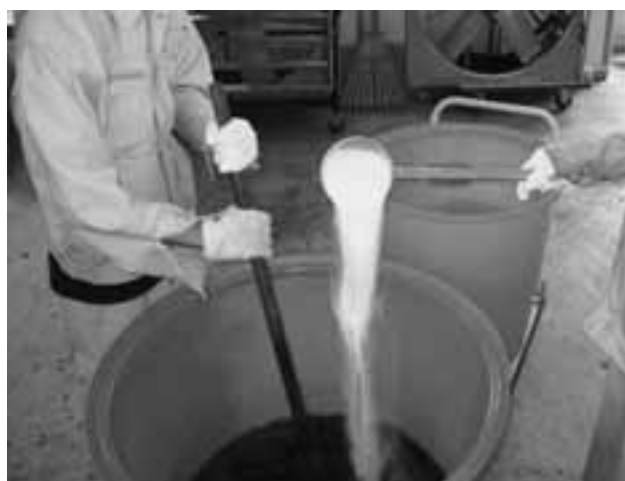
写真2 投入される添加物（ブドウ糖）
