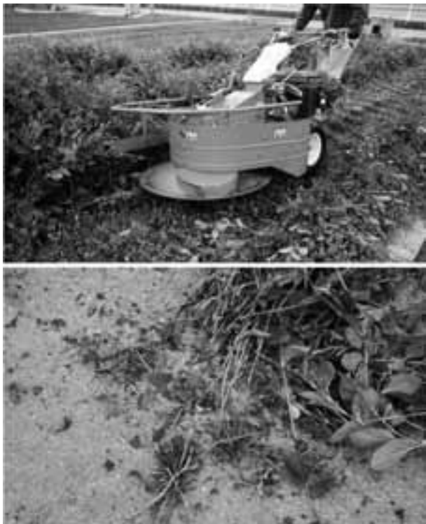
図6 歩行型ロータリーモアによるタデアイ収穫試験 上：ロータリーモアによる刈り取り 下：刈り取られた収穫物の下部が破碎されている
