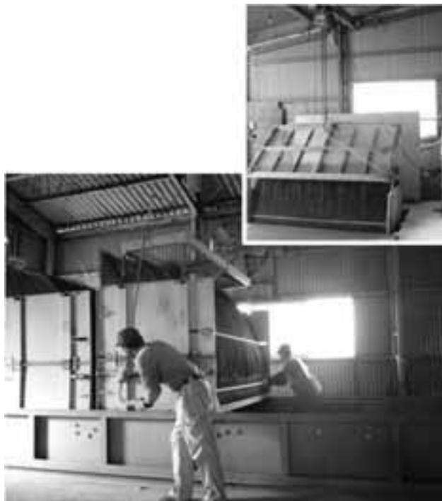
写真11 コンテナで泥染めから乾燥までを処理する大型乾燥機(システム乾燥機)
