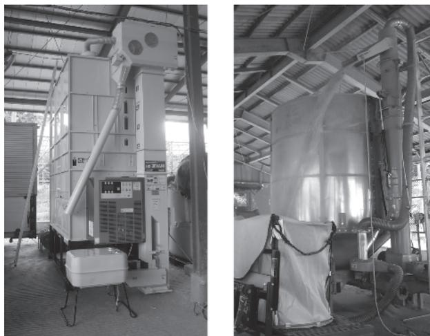
写真1. 循環式乾燥機(左)とモバイルドライヤー(右)
