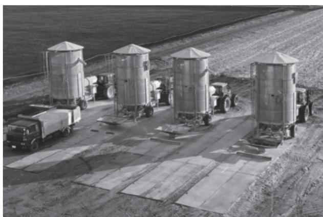
写真3. 二次拠点の海外から導入したトラクター駆動のモバイル型乾燥機
