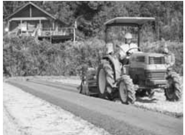
図4 畝立て表層散播作業機によるソバの播種
