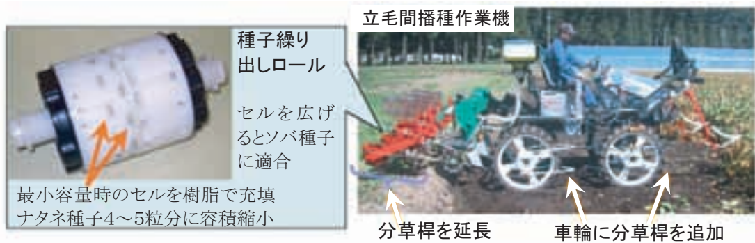
ソバ-ナタネ用に改造した立毛間播種機（23ページ参照）
