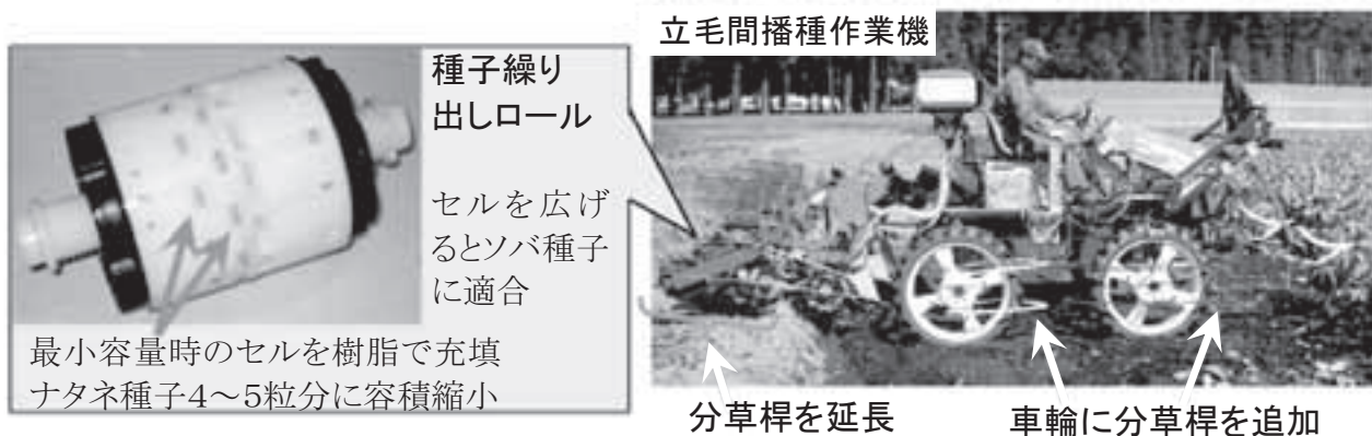
図1 ソバ-ナタネ用に改造した立毛間播種機
