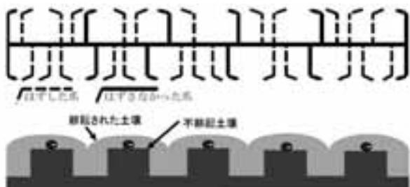
図2 ロータリの爪配置と播種位置の模式図
