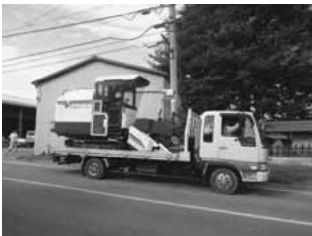
図2 4tトラックに積載された小型汎用コンバイン
