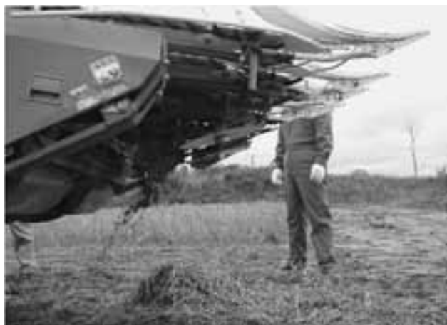
写真4 刈取部損失が最も低減される丸鋸刃仕様
