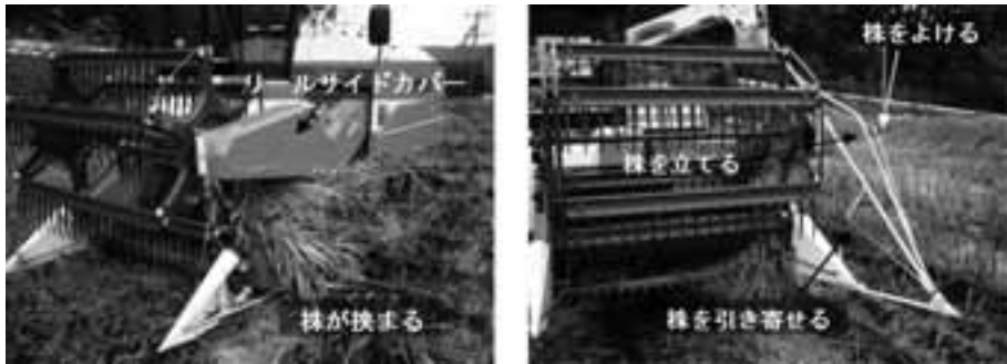
図4 デバイダ改良前のアワ収穫の様子(左)と改良後(右)
