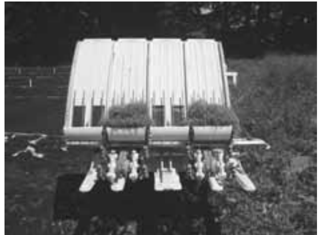
図1 田植機にヒエの苗をセットした状態
