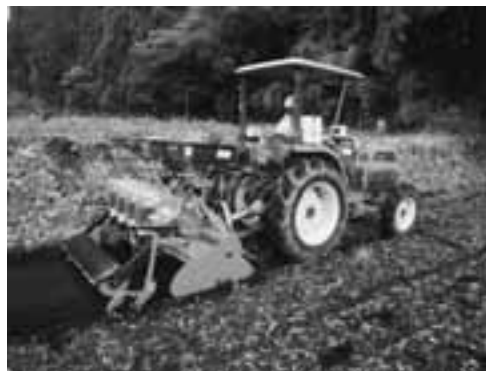
図9 アップカットロータリによる表層散播 写真：九州沖縄農業研究センター 土屋氏
