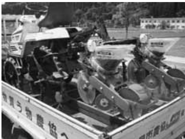
図2 田植機の植付部を撤去した自作の播種機
